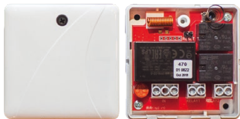
СН-Реле Беспроводное реле для управления домашними приборами
